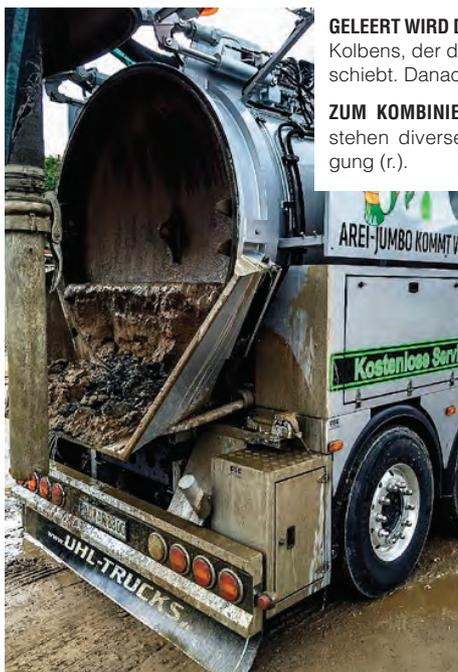
**GELEERT WIRD DER** Tank mithilfe eines Kolbens, der die Fäkalien zum Heck schiebt. Danach wird geputzt (l.).
